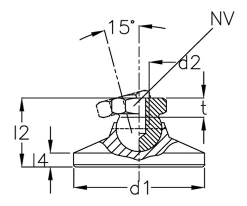
d1 = 60 d2 = 16 l2 = l4 = -NV = 24 Static load (kN) = 62 t min = 16
